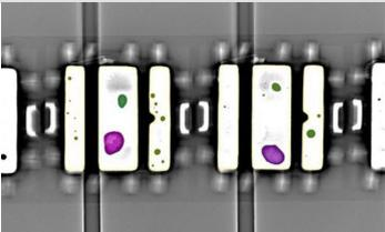
Voidinspect für die Voidanalyse in einer Laminografie Aufnahme
