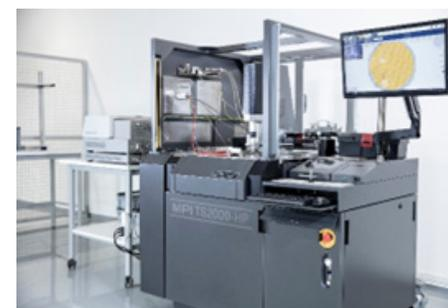
Das Prober System TS2000-HP ist für Messungen bis 10kV/600 A ausgelegt.
