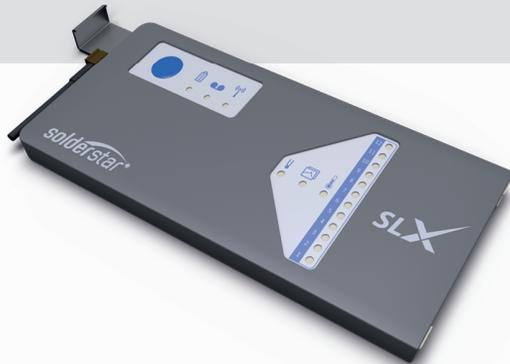
Avec les solutions d'enregistrement de Solderstar, nous mesurons, analysons et documentons les profils de température de vos fours à refusion.
