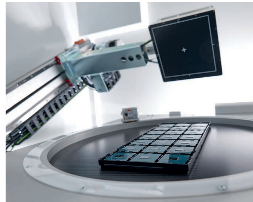
Automatisierte 2D- und Laminografie-Prüfung für höchste Produktivität.
