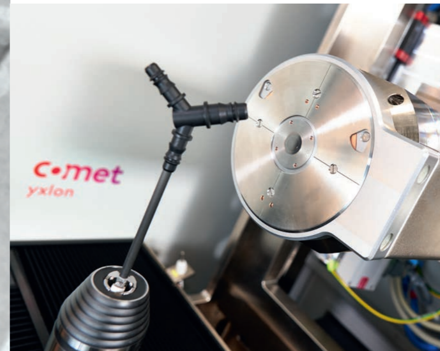
Die 190kV-Nanofokus-Transmissionsröhre des FF20 CT sorgt für hohe Detailsichtbarkeit.
