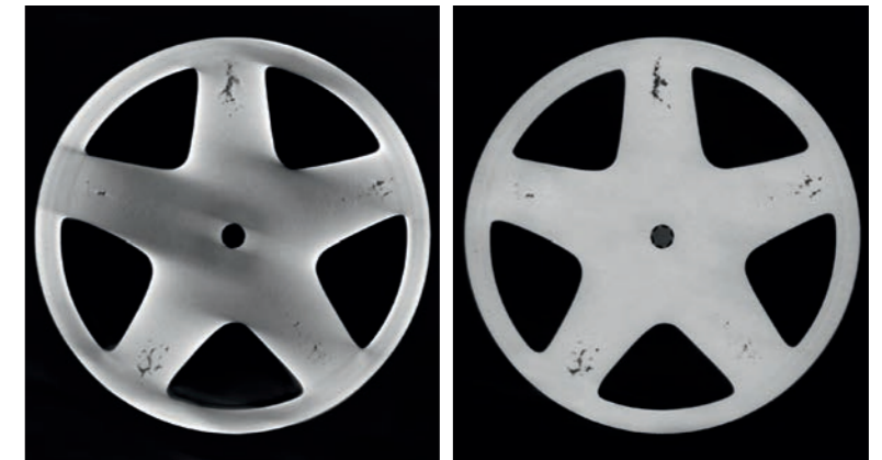
Unerwünschte Grauwertverläufe eliminieren: Kegelstrahl-CT ohne (links) und mit Strahlauhärtungskorrektur (rechts).
