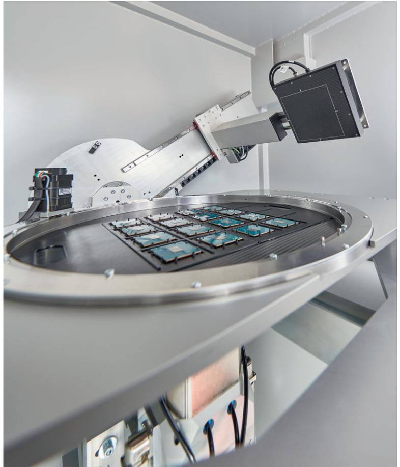
Detektorneigung, kontinuierliche 360°-Drehung des Probenhalters und stabile Röhre – die Basis für präzise, hochauflösende Prüfergebnisse.
