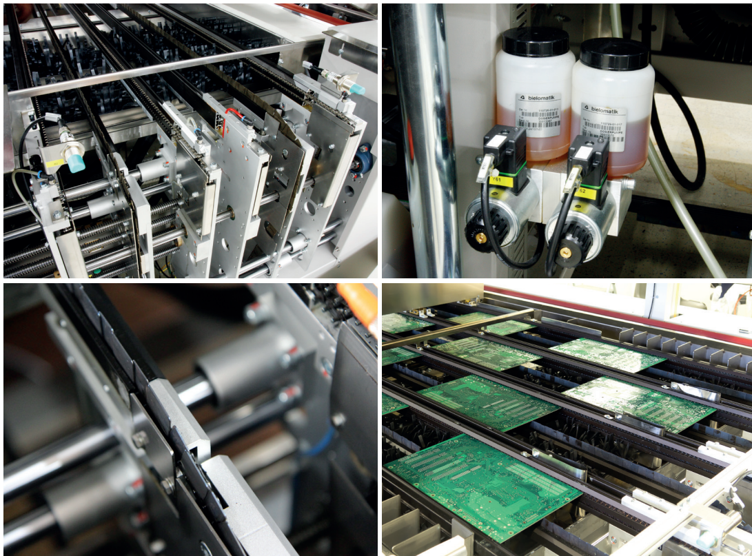
oben links: Doppelspur-Transport, oben rechts: Kettenöler unten links: Mittenunterstützung Laschenkette, unten rechts: Vierspür-Transport
